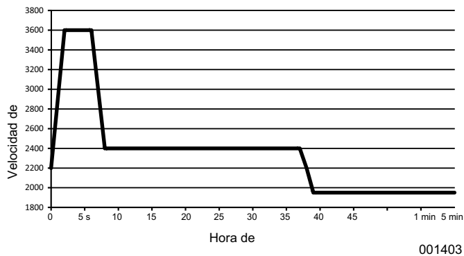
Figura 3-9. Perfil de baja velocidad del funcionamiento
