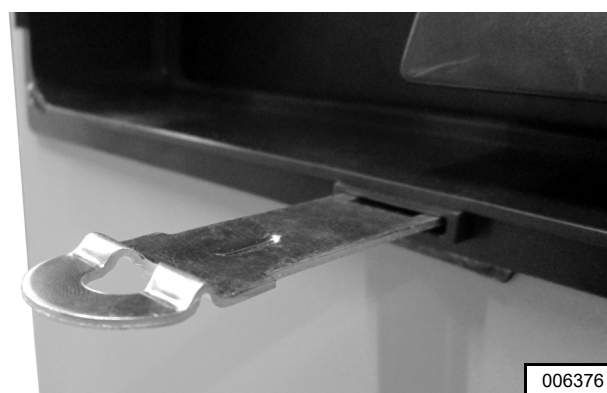
Figure 3-7. Pose du moraillon de hublot vitré
