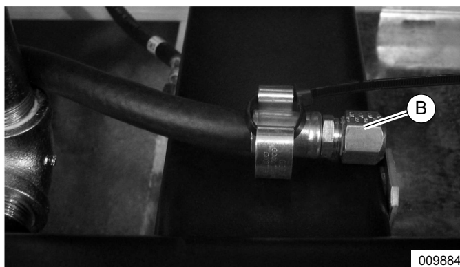
Figure 5-9. Collier de fixation du flexible de vidange d'huile
